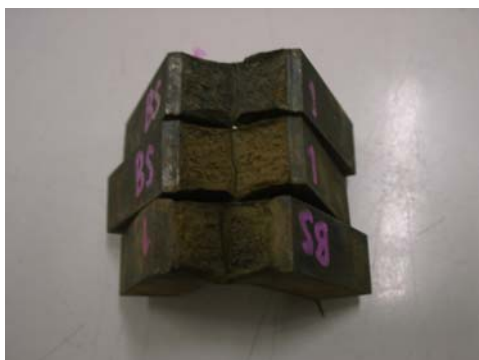
รูปที่ 1.12 ลักษณะพื้นที่รอยแตกแบบเปราะ และแบบเหนียวในการทดสอบแรงกระแทก
