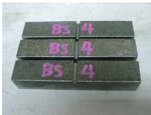
รูปที่ 1.10 : ลักษณะของชิ้นงานทดสอบและรอยบากร่อง
