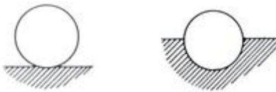
รูปที่ 1.17 : ลักษณะการทดสอบแบบ Brinell ที่ไม่ถูกต้อง
