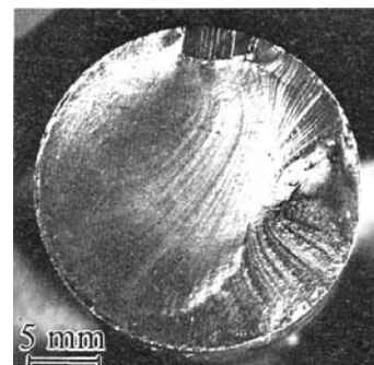
รูปที่ 1.14 : ลักษณะรอยขาดเนื่องจากการล้าตัว
