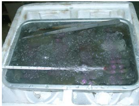
รูปที่ 1.11 : การแช่ชิ้นงานทดสอบในน้ำแข็งเพื่อลดอุณหภูมิให้ต่ำกว่า 0 องศา
