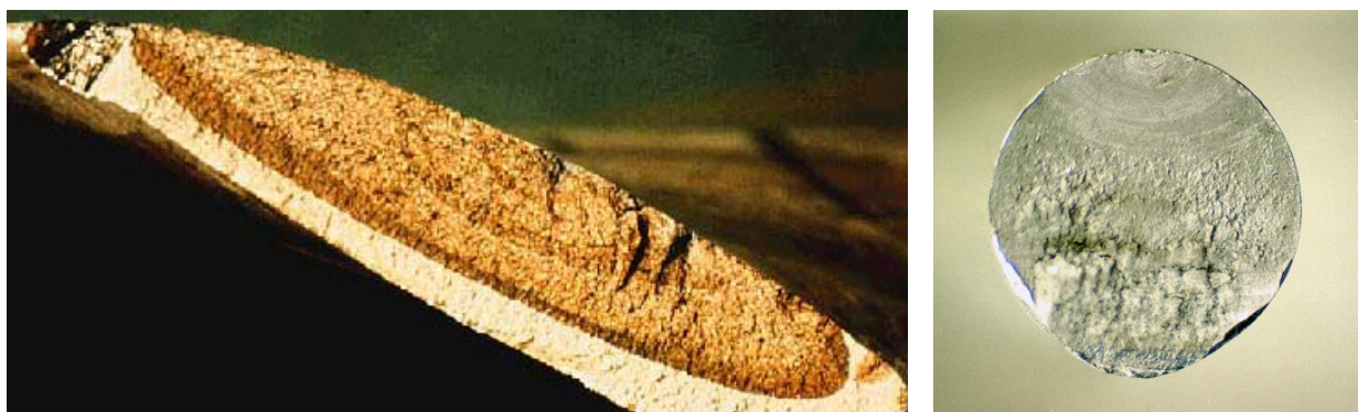
รูปที่ 2.10 ลักษณะของรอยแตกหักของโลหะเนื่องจากความล้า
