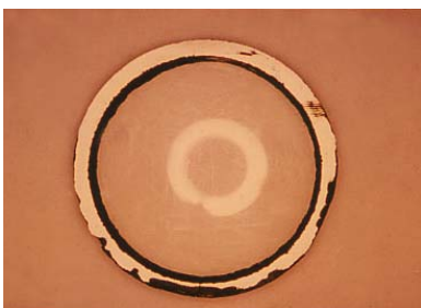
รูปที่ 2.14 ลักษณะการกัดกร่อนแบบ graphitization
