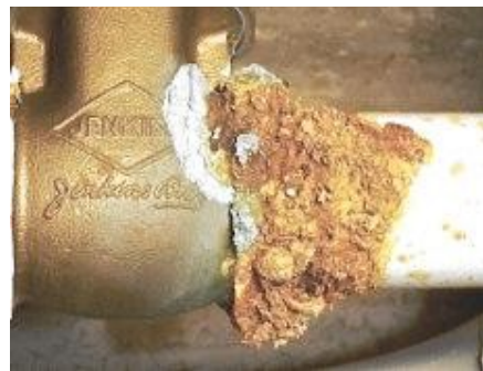
รูปที่ 2.4 ลักษณะการกัดกร่อนแบบ Galvanic Corrosion
