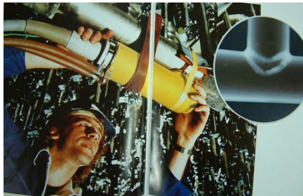
รูปที่ 13 ใช้รังสีแกมมาในการถ่ายภาพโลหะ
