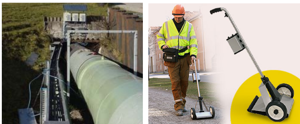
รูปที่ 11 การตรวจสอบการรั่วของน้ำมันในท่อใต้ดิน โดยการใช้เครื่องตรวจวัดกัมมันตรังสี
