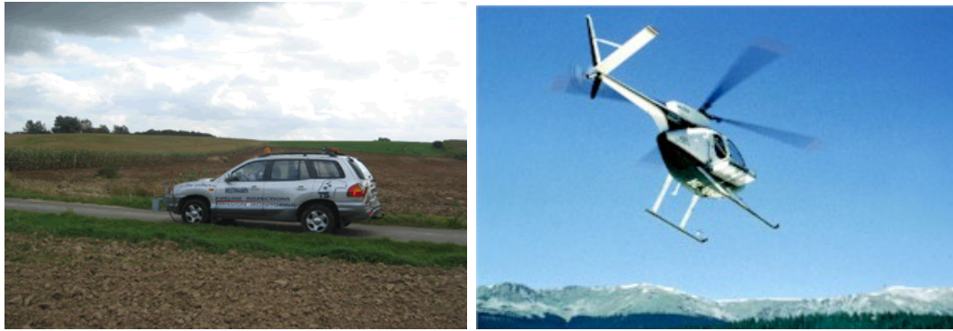
รูปที่ 12 การตรวจสอบการรั่วของน้ำมัน โดยการใช้เครื่องตรวจวัดกัมมันตรังสีที่ติดตั้งในยานพาหนะ
