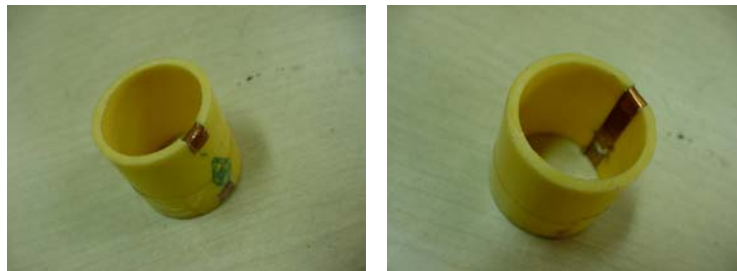
รูปที่ 4 ภาพการติดตั้งแผ่นทองแดงเข้ากับท่อพีวีซี(3)
