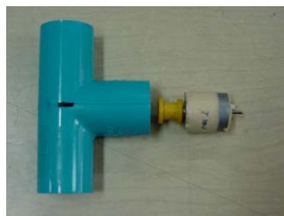
รูปที่ 8 ภาพการประกอบมอเตอร์เข้ากับท่อฟิวส์สามทาง
