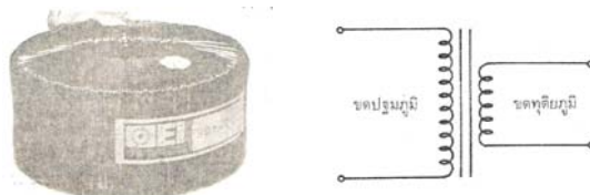
ภาพที่ 30 รูปร่างและสัญลักษณ์ตัวเหนี่ยวนำทอรอยด์ ทรานเฟอร์เมอร์ ที่มา: พันธุ์ศักดิ์ พุฒิमानิตพงศ์ 2541 : 179
