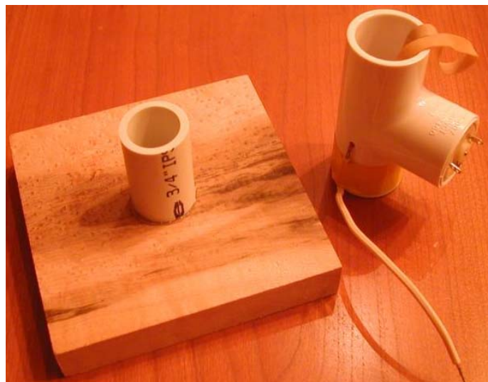
รูปที่ 7 ภาพการประกอบมอเตอร์เข้ากับท่อพีวีซีสามทาง
