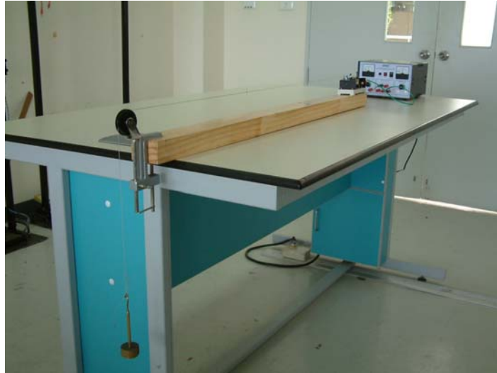
รูปที่ 2 แสดงการจัดตั้งอุปกรณ์การทดลองคลื่นนิ่งในเส้นเชือก
