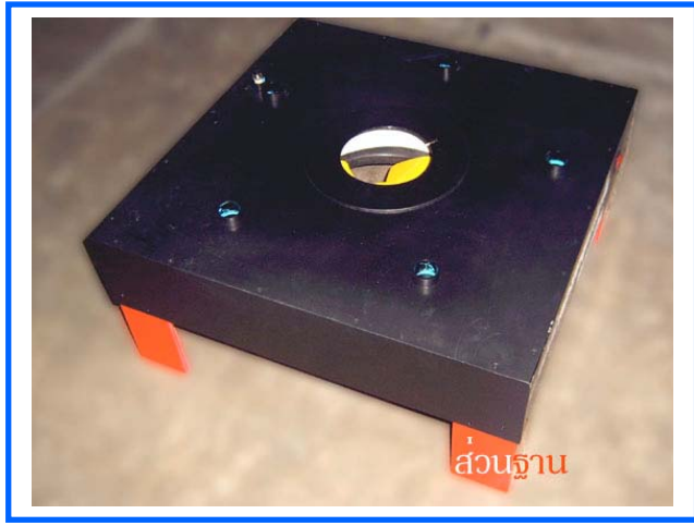
ภาพแสดงส่วนฐาน จะเห็นพัดลมอัดอากาศ
