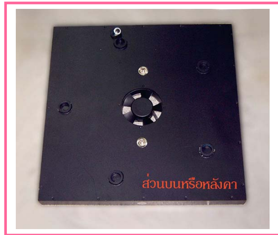
ภาพแสดงโครงสร้างส่วนดูดอากาศ ประกอบด้วยตัวกล่อง ตัวยึดเสา หลอดไฟและพัดลมดูดอากาศเพื่อดูดหมอกให้ยกตัวสูงขึ้น
