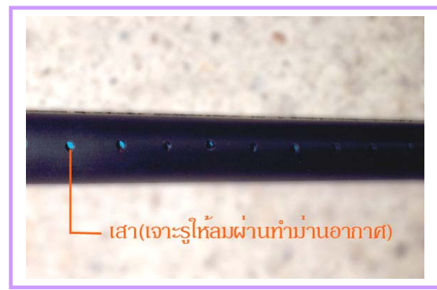
เสา นอกจากทำหน้าที่ทำม่านอากาศแล้ว ยังทำหน้าที่ค้ำยันหลังคาหรือโครงสร้างส่วนดูดอากาศ
