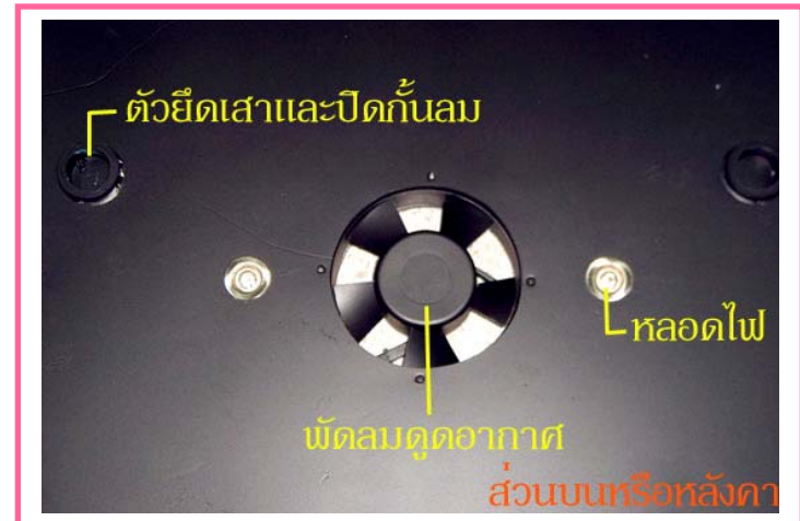
ภาพแสดงโครงสร้างส่วนดูดอากาศ ประกอบด้วยตัวกล่อง ตัวยึดเสา หลอดไฟและพัดลมดูดอากาศเพื่อดูดหมอกให้ยกตัวสูงขึ้น
