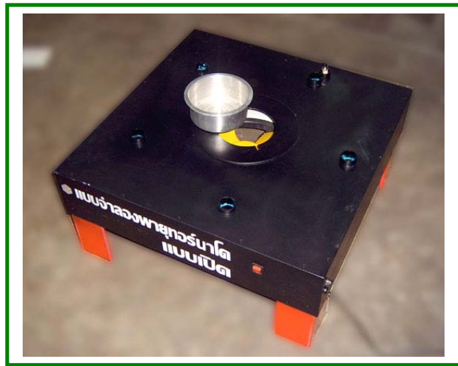
ภาพแสดงการใส่ภาชนะสำหรับเครื่องทำวันเหนือพัดลมอัดอากาศ
