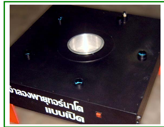
ภาพแสดงการใส่ภาชนะสำหรับเครื่องทำวันเหนือพัดลมอัดอากาศ
