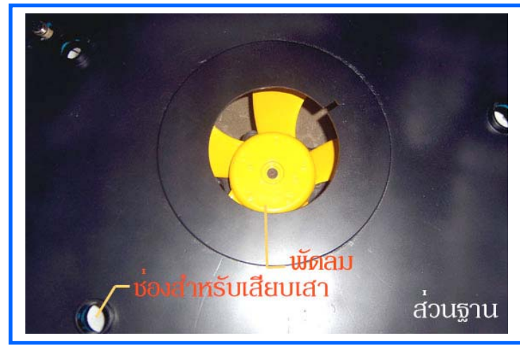
ภาพแสดงส่วนฐาน จะเห็นพัดลมอัดอากาศ
